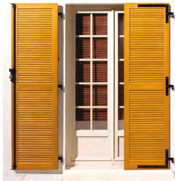
Volet à lames faux persienné plein Lames de 45 x 27 mm dans un bâti de 32 mm avec traverse intermédiaire à partir d'une hauteur de 1750 mm.
