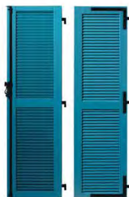
Volet persienné ajouré à l'américaine Lames de 38 x 10 mm dans un bâti de 32 mm avec traverse intermédiaire à partir d'une hauteur de 1750 mm.
