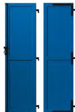
Volet plein Remplissage en contre-plaqué de 10 mm dans un cadre de 32 mm avec traverse intermédiaire à partir d'une hauteur de 1750 mm.
